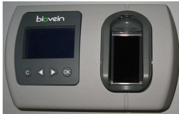
Nettoyer les bords du capteur à l'aide d'un chiffon propre et sec
