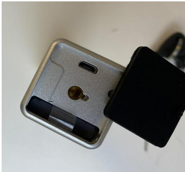
Positionner la languette en plastique afin qu'elle ne gêne pas la remise en place du capuchon d'étanchéité
